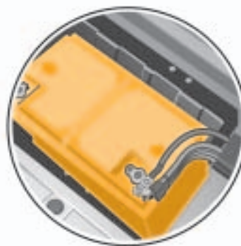
Sicherungshalter (SA), rechts an der Batterie, erst nach Ausbau sichtbar
